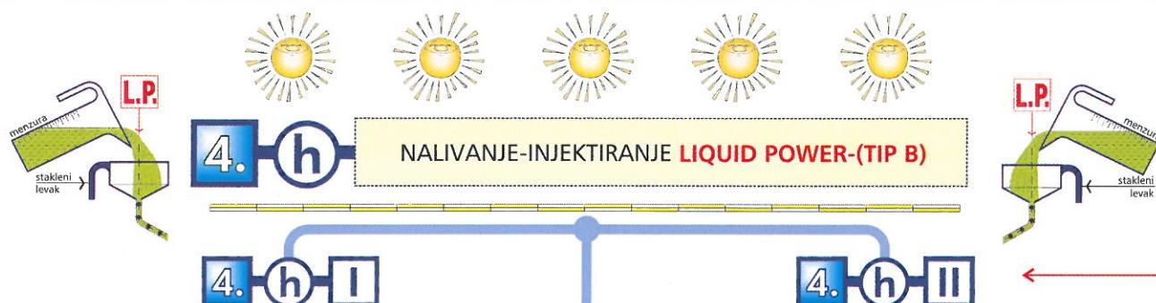
Sistem izvođenja hidroizolacije mešavinom **{TP-LP-4MS (Tip B)}** plus voda koja odgovara zapremini rupa na jednom metru dužnom zida.
