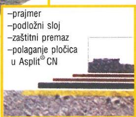
■ **Asplit® CN** je dvokomponentna sintetička smola koja očvršćava na normalnoj temperaturi i dobija se mešanjem modifikovanog fenol rezola i punioca na bazi grafita.
