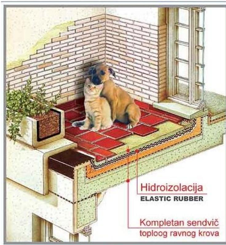
TOPLI RAVAN KROV - aksonometrija (teška zaštita - keramičke pločice)
