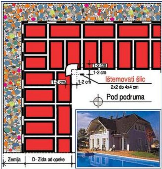
**Detalj 4b. OBRADA ŠLICA NA SPOJU ZIDOVA OD OPEKE U UGLU PO VERTIKALI.** Na spoju zidova od opeke u uglu po vertikali ištemovati šlic dimenzija 2x2cm i 4x4cm, da ravnomerno zahvati oba zida, kao na skici. Novo ištemovani šlic dobro oprati i zasiliti vodom, pa tek onda izvoditi prvi premaz **TP-4MS**. Između drugog i trećeg premaza **TP-4MS** šlic popuniti utiskivanjem špahtlom ili mistrijom **TP-4MS-MALTERA**.
