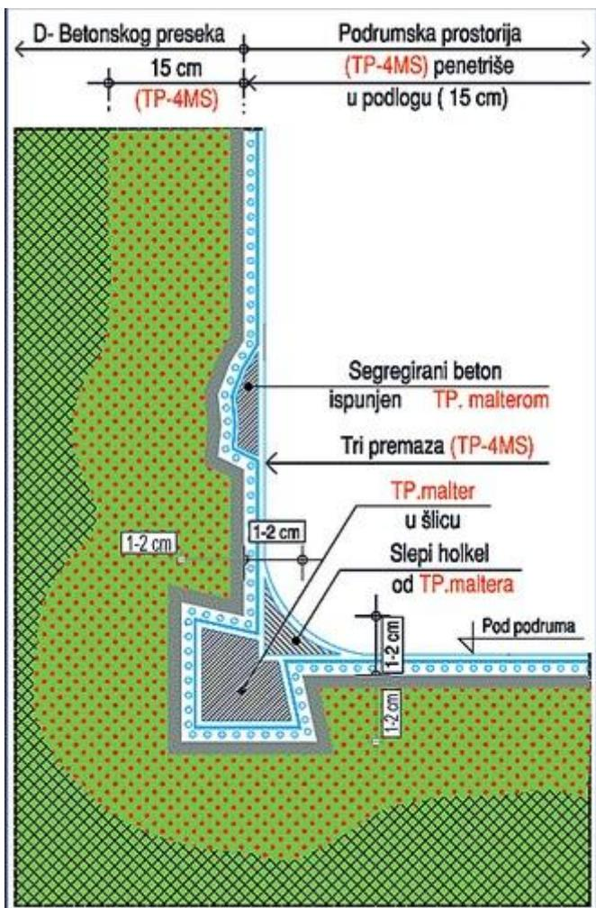
**DETALJ 6i: IZRADA HIDROIZOLACIJE TP-4MS - OBRADA ŠLICA NA SPOJU PODA I ZIDA OD BETONA.** Šlic na spoja poda i zida u uglu po obimu prostorije, koji je dobro pripremljen i po uputstvu dobro zasititi vodom i naneti prvi premaz **TP-4MS**. Posle 24h, prvi premaz dobro nakvasiti i naneti drugi premaz **TP-4MS**. Posle 24h, drugi premaz dobro nakvasiti i ispuniti **MALTEROM TP-4MS** i naneti treći premaz **TP-4MS**. Sva tri premaza su debljine cca 3mm.
