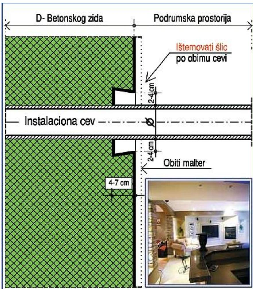
**Detalj 9a. OBRADA PRODORA CEVI KROZ BETONSKI ZID.** Po obimu prodora cevi ištemovati šlic dubine 2cm i širine 2cm (ovo važi kada nema velikog pritiska vode). Novo ištemovani šlic dobro oprati, podlogu zasititi vodom, pa tek onda izvoditi prvi premaz **TP-4MS**. Između drugog i trećeg premaza **TP-4MS** šlic popuniti utiskivanjem špahtlom ili mistrijom **TP-4MS**
