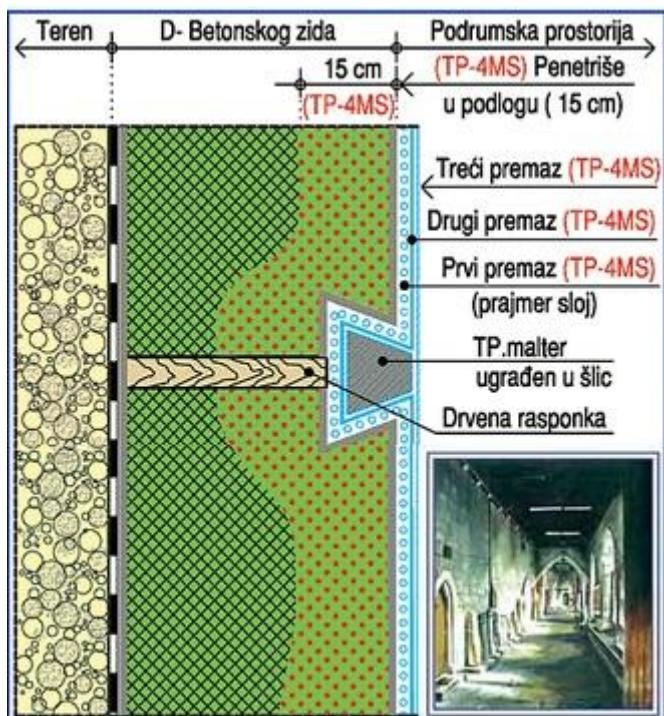
**DETALJ 2i: IZRADA HIDROIZOLACIJE TP-4MS - OBRADA RASPONKE.** Na pripremljenu betonsku podlogu, prema uputstvu isštemovano udubljenje, kod rasponke, dobro zasititi vodom, pa naneti prvi premaz **TP-4MS**. Nakon 24h drugi premaz dobro nakvasiti i udubljenje ispuniti **MALTEROM TP-4MS** i naneti treći premaz **TP-4MS**. Sva tri premaza su debljine cca 3mm.
