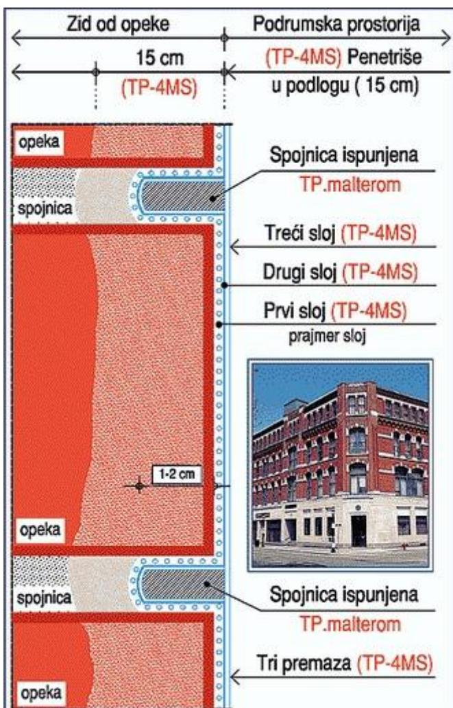
**DETALJ 7i: IZRADA HIDROIZOLACIJE TP-4MS NA ZIDU OD OPEKE.** Zid od opeke pripremljen po uputstvu, obijen malter, očišćene spojnice i podloga zasićena vodom. Naneti prvi premaz **TP-4MS**. Posle 24h, prvi premaz dobro nakvasiti i naneti drugi premaz **TP-4MS**. Nakon 24h drugi premaz dobro nakvasiti i spojnice ispuniti **MALTEROM TP-4MS**, izdresovati spojnice, naneti treći premaz **TP-4MS**. Sva tri premaza su debljine cca 3mm.
