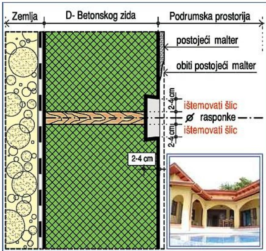
**Detalj 8a. OBRADA RASPONKI, DRVENIH, METALNIH ILI PLASTIČNIH.** Kod rasponki, armature ili žice koja viri iz betonske podloge, ištemovati udubljenje prema skici, i zaseći rasponku, udubljenje oprati vodom i zasititi betonsku podlogu kvašenjem, pa tek onda izvoditi prvi premaz TP-4MS. Između drugog i trećeg premaza TP-4MS izvršiti popunu udubljenja **TP-4MS MALTEROM** pomoću špahtle ili mistrije, utiskivanjem.
