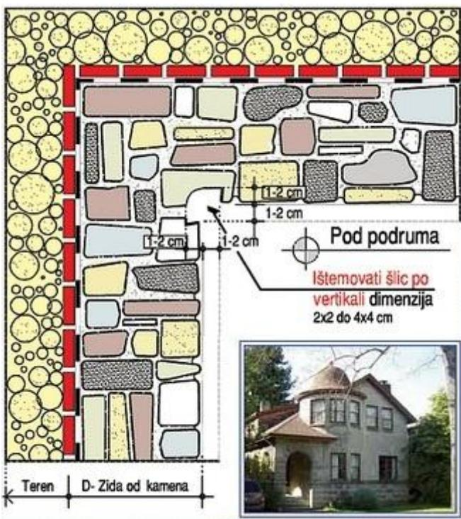
**Detalj 4c. OBRADA ŠLICA NA SPOJU ZIDOVA OD KAMENA U UGLU PO VERTIKALI.** Na spoju zidova od kamena u uglu po vertikali ištemovati šlic dimenzija 2x2cm do 4x4cm, da ravnomerno zahvati oba zida, kao na skici. Novo ištemovani šlic dobro oprati i zasititi vodom, pa tek onda izvoditi prvi premaz TP-4MS. Između drugog i trećeg premaza TP-4MS šlic popuniti utiskivanjem špahtlom ili mistrijom sa **TP-4MS-MALTEROM**.
