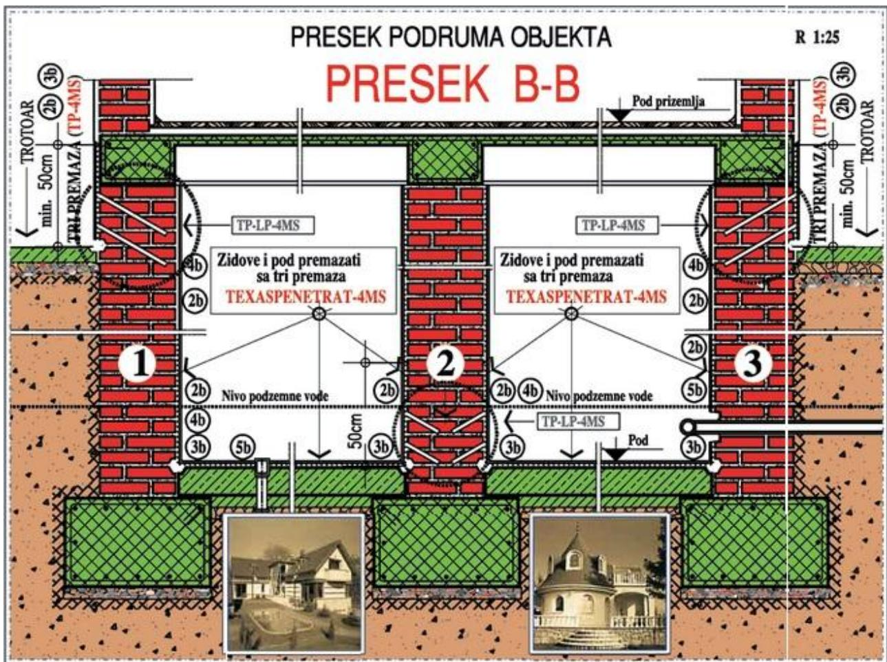
**Detalj 1b. IZRADA HIDROIZOLACIJE TP-4MS NA PODLOZI OD OPEKE.** Na preseku podruma(b-b) zidanog od opeke arapskim brojevima su označeni karakteristični detalji za prvu fazu radova (pripremni radovi) (1.b)
