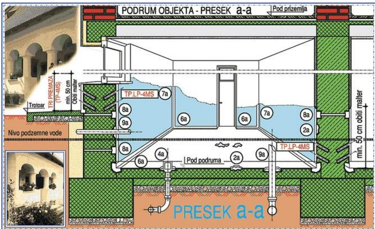
**Detalj (1a), IZRADA HIDROIZOLACIJE TP-4MS -om NA PODLOZI OD BETONA.** Na preseku podruma (a-a) izvedenog sa zidovima od betona, arapskim brojevima označeni su karakteristični detalji za prvu fazu radova - pripremni radovi (1.a)
