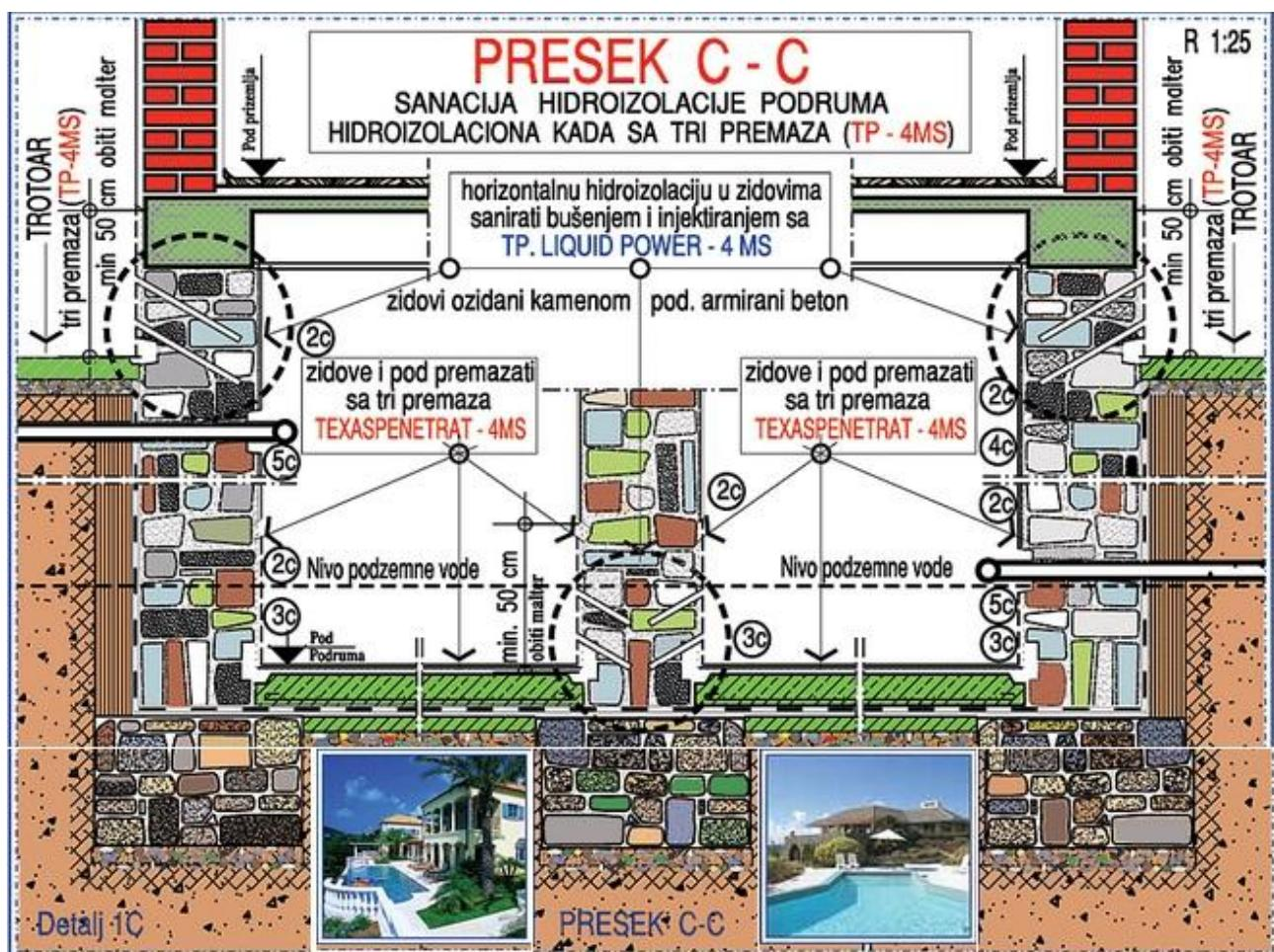
**Detalj 1c. IZRADA HIDROIZOLACIJE (TP-4MS) NA PODLOZI OD KAMENA.** Na preseku podruma (c-c) zidanog od kamena, arapskim brojevima označeni su karakteristični detalji za prvu fazu radova (pripremni radovi) (1 b).
