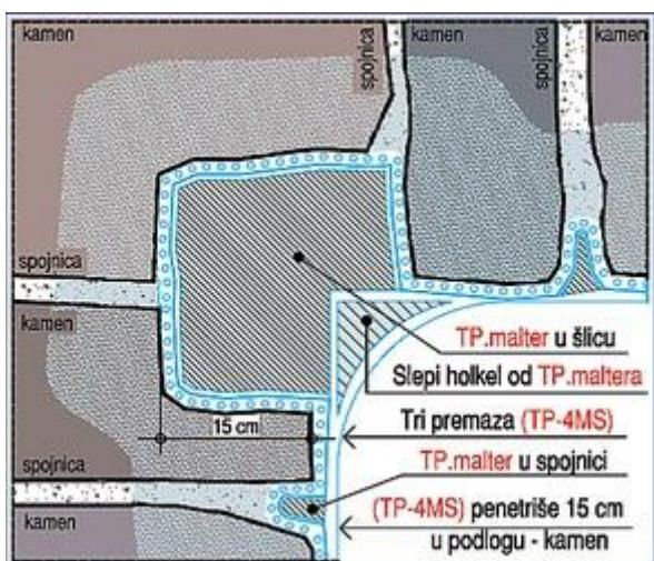
**DETALJ 5i:** SPOJ KAMENIH ZIDOVA U UGLU PO VERTIKALI OBRAĐENI HIDROIZOLACIJOM TP-4MS.
